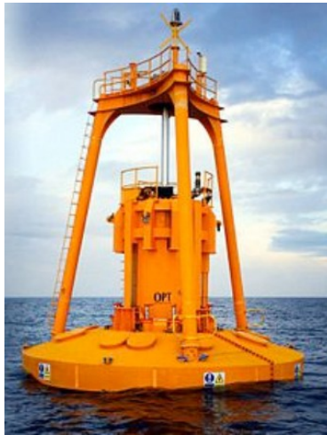
Figure 1 : Génératrice houlomotrice par l'entreprise OPT
